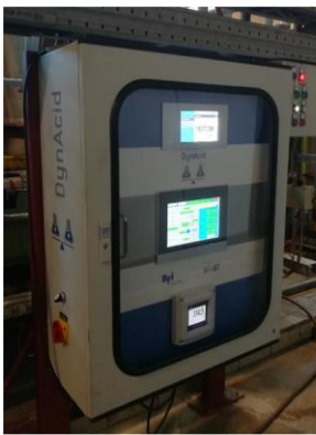
BFI-Online-Konzentrations-Messtechnik für H_2SO_4 -Zn-Säurelösungen (Demonstrator-Installation an industrieller Prozessanlage)
