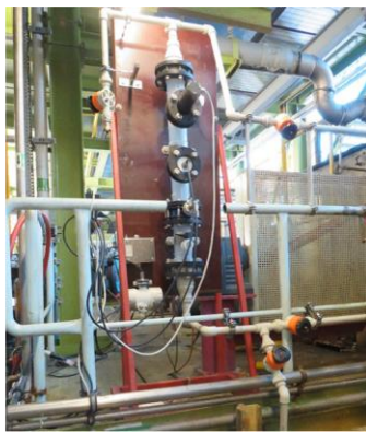
BFI-Online-Konzentrations-Messtechnik für H_2SO_4 -Zn-Säurelösungen (Demonstrator-Installation an industrieller Prozessanlage)
