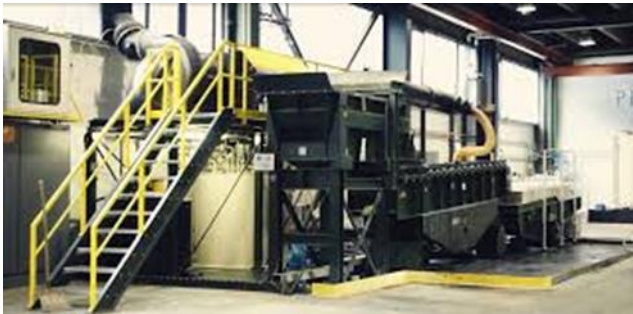
Stahlschrott-Entzinkungsanlage im Pilotmaßstab (Quelle: PROASSORT GmbH)
