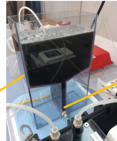
Vorlagebehälter mit keramischer Flachmembran
