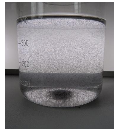
Gefälltes Calciumfluorid mit magnetisierbaren Partikeln
