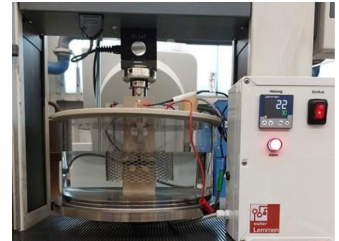
Elektrochemische Messzelle mit 4PB-Vorrichtung für in-situ Versuche (BFI)
