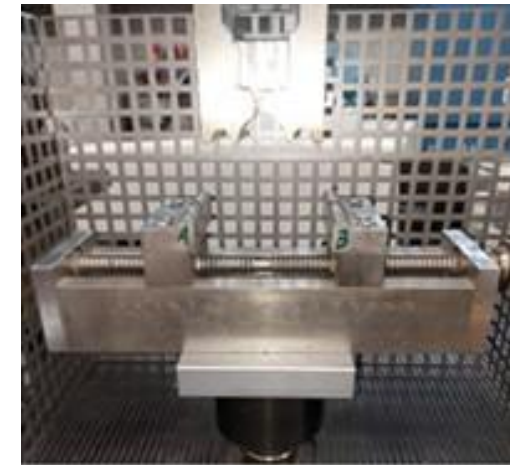
4PB-Vorrichtung für bruchmechanische Versuche (BFI)
